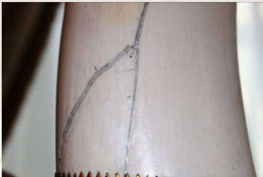
پر شدن درز ترکها توسط موم میکرو کریستال گرم شده
