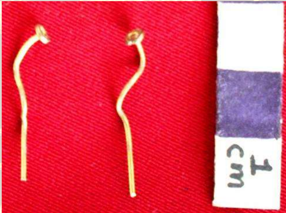
میخهای برنجی جهت اتصال قطعات کریستالی به یکدیگر
