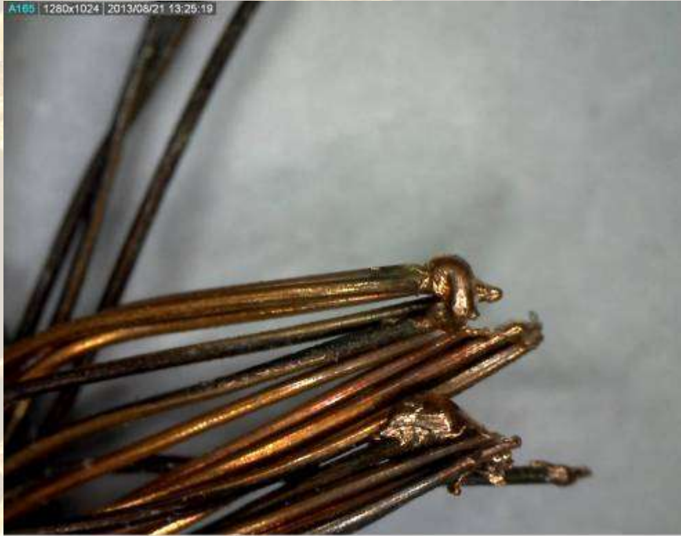
نمونه رشته سیم های داخل کابل برق لوستر (24رشته) مسی و کاملاً ترد و اکسید شده
