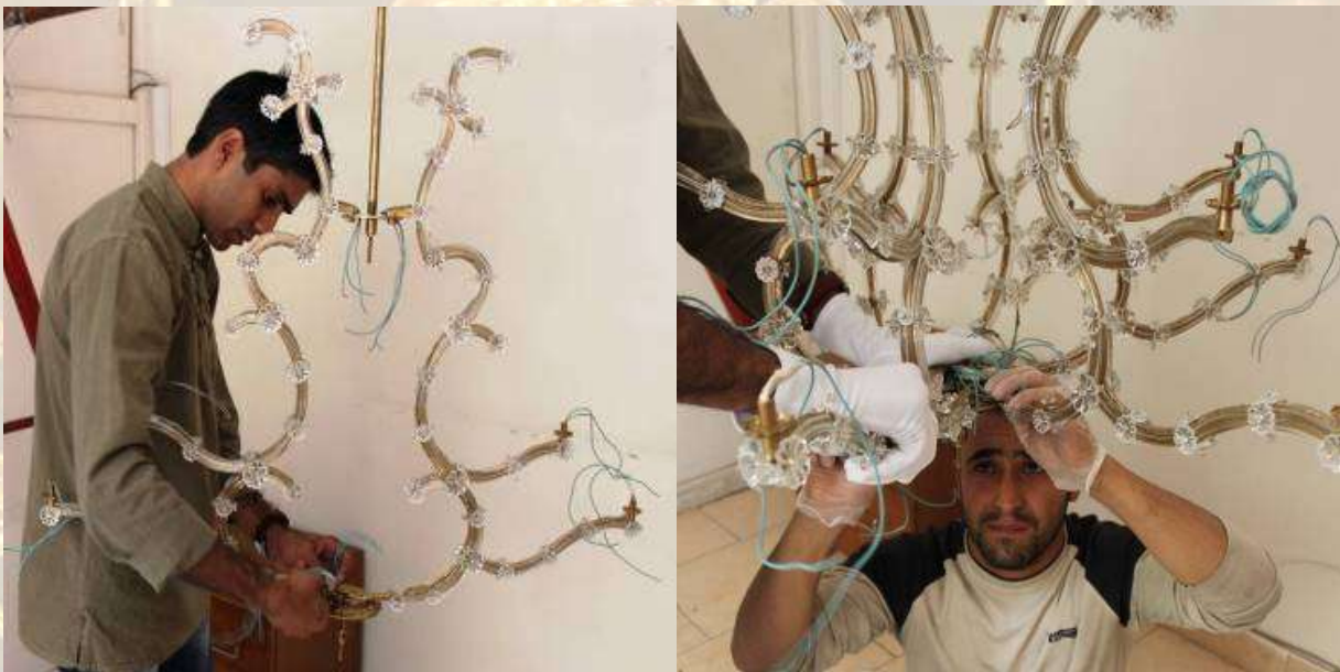
نصب اسکلت اولیه لوستر به پلیت بالا و پایین اتصال شاخه های آماده شده به پلیت های بالا و پایین
