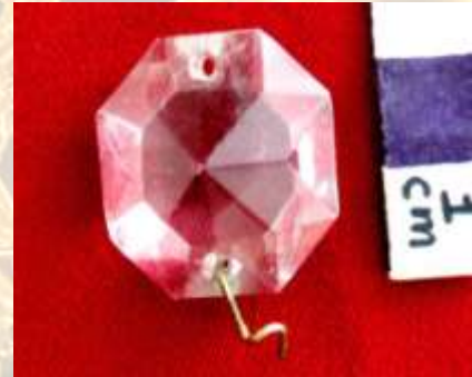
قطعات مجوف شیشه ای تخت ، برای پوشاندن سطح شاخه های فلزی لوستر
