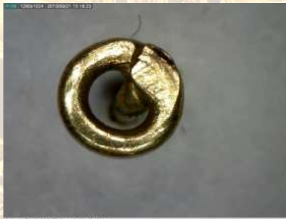
میخ برنجی دست ساز 50x با رد ضربه و برش جهت ساخت
