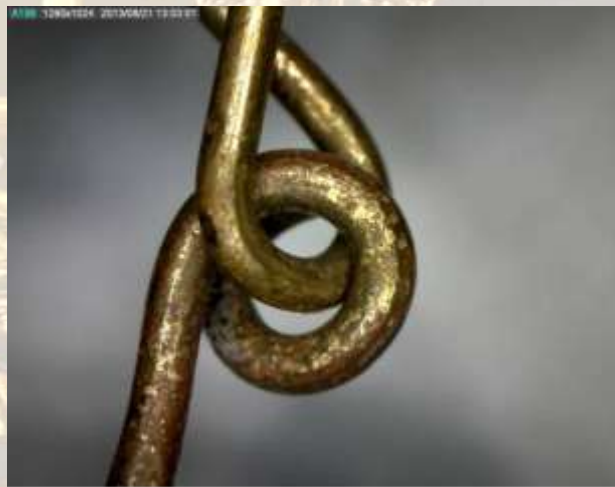
نحوه اتصالات پین های برنزی جهت نگهداشتن قطعات کریستالی به یکدیگر 50x
